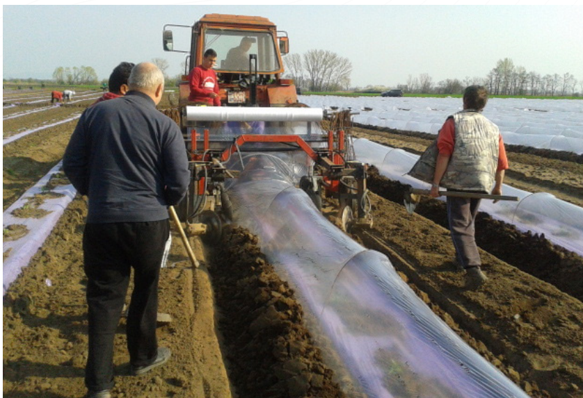
4. ábra – Fóliaalagút telepítése speciális berendezéssel
